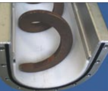
Transportør med akselløs snegl og slidforing til transport af slam og ristegods.
